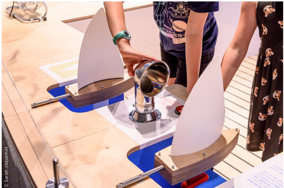
**Descr. élément(s):** 2 petits voiliers - avec/sans quille lestée - sur axe, manche à air orientable, bouton d'activation de la ventilation (sur minuteur)
